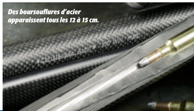
Le canon est ensuite habillé alternativement de 5 couches de feuilles longitudinales de 1,5 mm d'épaisseur.
