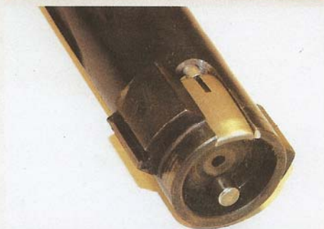
Cabeza del cerrojo, donde se aprecian la una extractora basculante y el expulsor activo.
