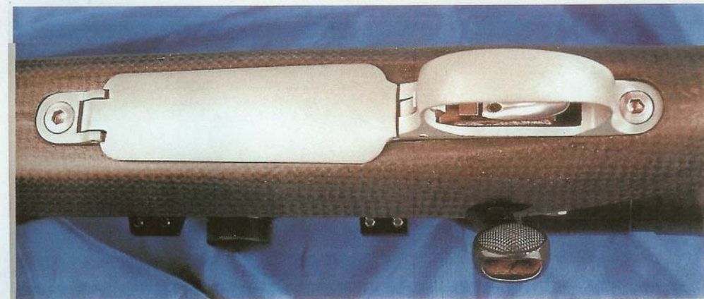
Lo sportello inferiore per lo svuotamento rapido del serbatoio si sblocca agendo sul pulsante posto all'interno della guardia del grilletto.
